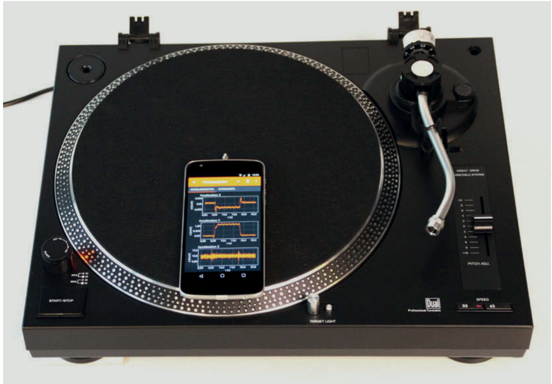
▲ Abb. 1 Mit seinen integrierten Sensoren kann das Smartphone Beschleunigung und Kreisfrequenz auf dem Plattenspieler messen (hier mithilfe der App phyphox).
