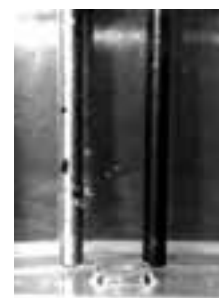
■ Abb. 7b: Goldfarbene, maximal lithiierte Bleistiftmine
